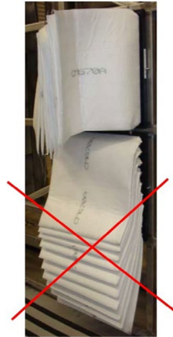
Posefiltre skal altid installeres stående
